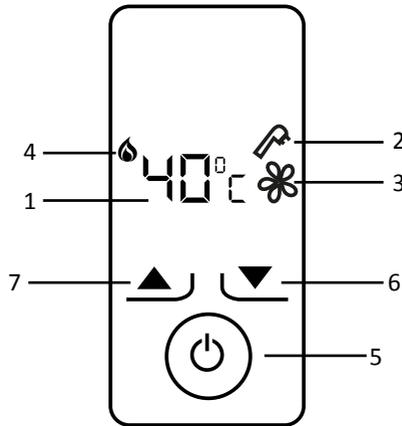
**1. Temperatura selecionada e código de erro.** Indica a temperatura selecionada e os códigos de erro segundo tabela Códigos de Falha. A temperatura que aparece no display é a da temperatura de saída de água. Sempre que é ajustado a temperatura aparecerá a temperatura esperada, logo após voltará a indicar a temperatura de saída da água.
