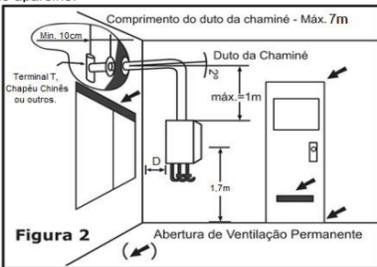
Exemplos de Abertura de Ventilação Permanente
