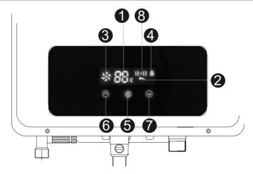
1. Temperatura selecionada e código de erro. Indica a temperatura selecionada e os códigos de erro segundo tabela Códigos de Falha. A temperatura que aparece no display é a da temperatura de saída de água. Sempre que é ajustado a temperatura aparecerá a temperatura esperada, logo após voltará a indicar a temperatura de saída da água.
