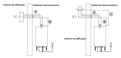
Trecho A (comprimento total) deve ser de no máximo 4,5 m com uso de 2 curvas;
